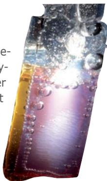
*Hämatit Photoanode, an deren Oberfläche Wasser zu Sauerstoff oxidiert wird. Wasserstoff entsteht an einer Platin-Gegenelektrode*
